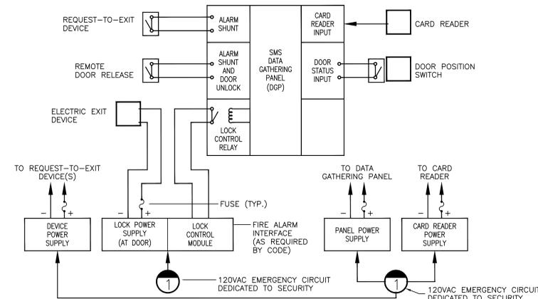
**3 TYPICAL CARD READER - ELECTRIC EXIT DEVICE BLOCK DIAGRAM**
