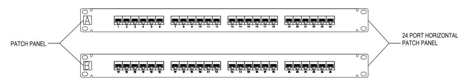
3 TYPICAL COPPER BACKBONE LABELING SCHEME
